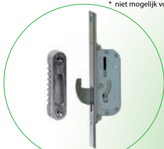
Boven- en onderzijde Zijn voorzien van schuin toelopende haakschoten met sluitkom.
