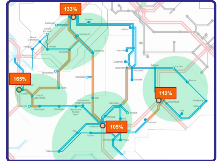
Overzichtskartaal met overbelaste verbindingen (2029) in oranje weergegeven. Hoogste knelpunten op koppeltransformatoren (in referentiesituatie 2029 met decentrale flex) zijn procentueel weergegeven.
